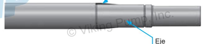
**NOTA:** Aplique una capa de lubricante P-80® o equivalente en el eje del rotor, el manguito de instalación ahusado y el diámetro interior del sello mecánico antes del montaje.
